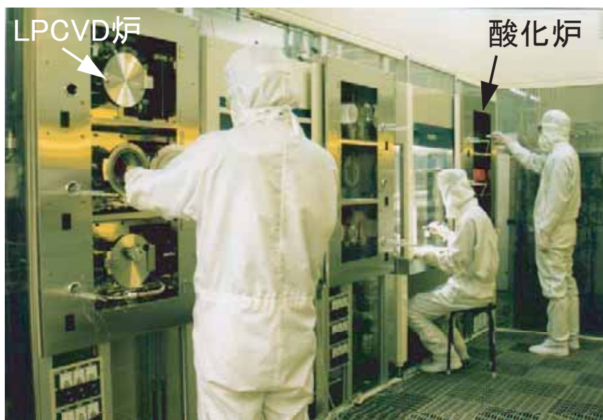
図 IV. 5. 9 クリーンルームにおける Si 熱酸化および LPCVD 作業の様子
