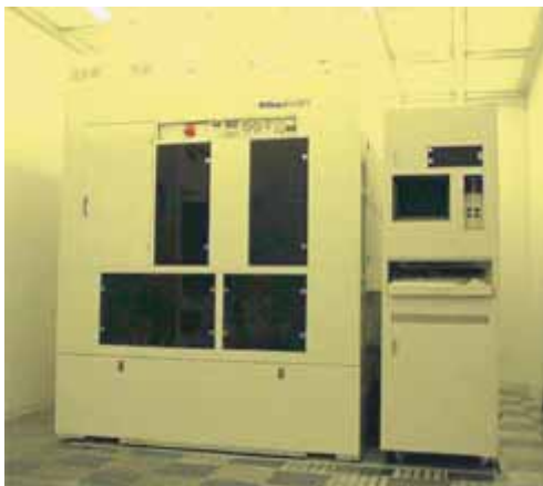
図 IV. 3. 4 フォトリソグラフィ装置：ステッパの写真（広島大学ナノデバイス・バイオ融合科学研究所提供）と内部構造
