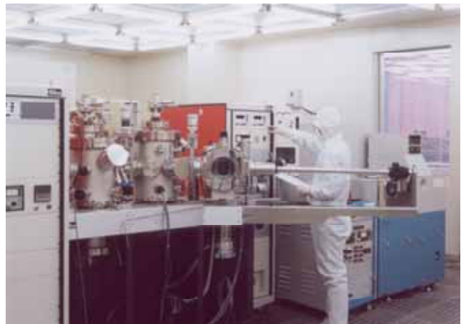
図 IV. 5. 22 スパッタ装置（超高真空仕様：広島大学ナノデバイス・バイオ融合科学研究所）
