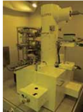
図 IV. 3. 9 電子ビーム露光装置の写真（広島大学ナノデバイス・バイオ融合科学研究所提供） 解像度は 6nm
