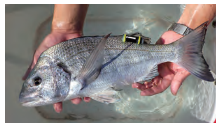
クロダイの背びれあたりに「小型超音波発信器」を装着。機器の寿命がもつ限り、追跡と並行し遊泳深度も記録できる
