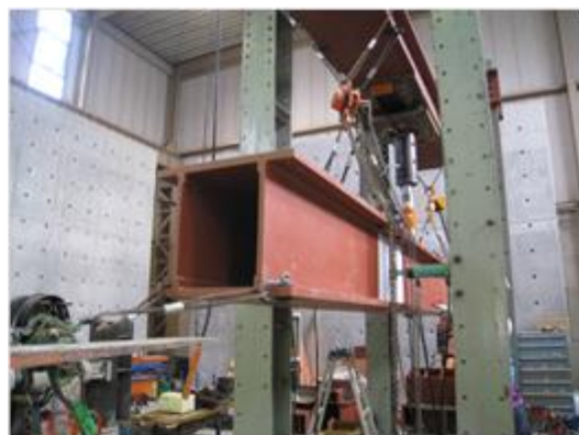
4. 水平ジャッキ、パンタグラフの取り外し
