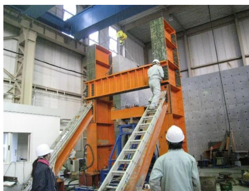
図1 梯子を使用した組換え作業
