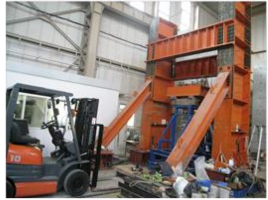
4. クレーンで梁を上げボルトナットを取付ける
