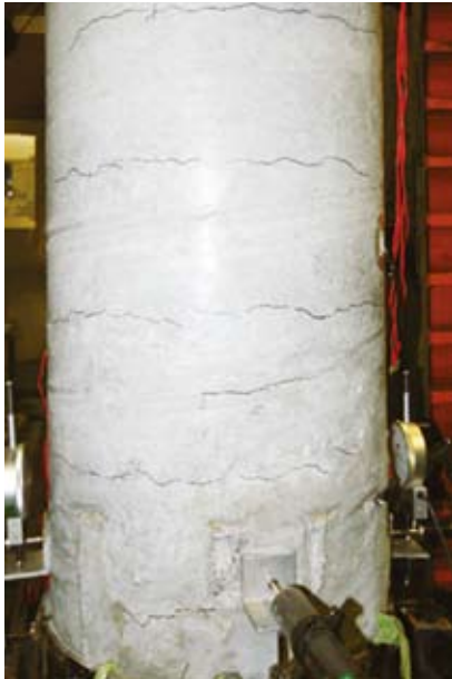
写真-3 ひび割れの様子 (No.3)
