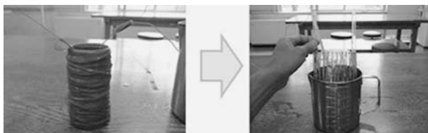
図8 加熱効率向上接触不良防止 (温度特性 測定サンプル)
