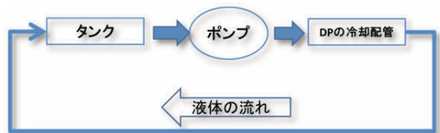
図 5: 冷却管と洗浄に必要な器具の構成図
