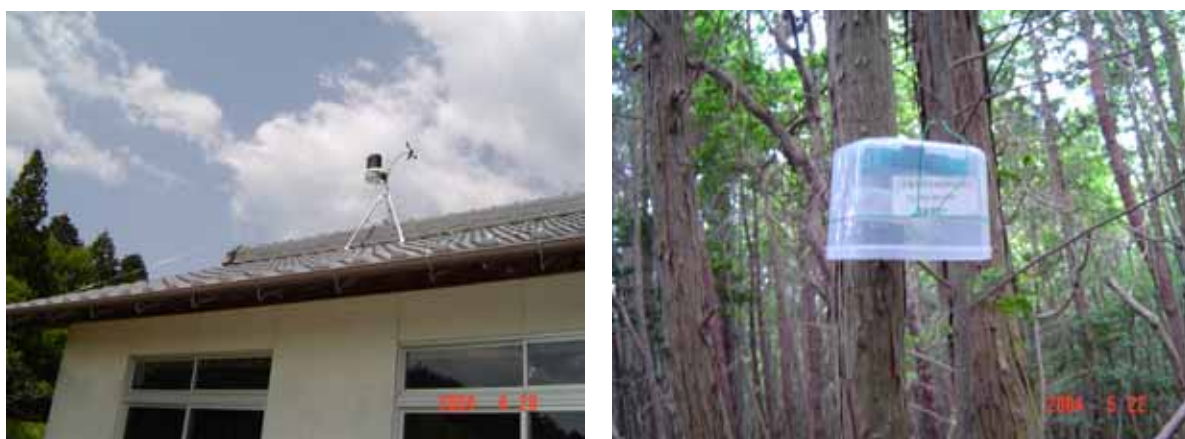
図 4.8 集会所屋上に設置されたヴァンテージ・プロの屋外センサー（左）と、候補地の山中に設置されたエコログ（右；雨よけのカバーの中に据えてある）
