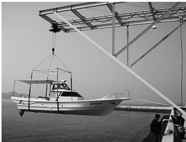
小型船舶を吊り上げている様子
