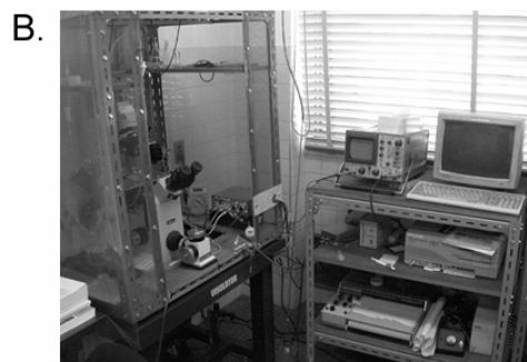
図 3. ホールセルパッチクランプ法。A：電位固定法の概念図。B：実験に使用している機器群。
