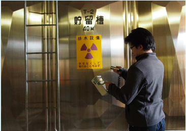
線量率の測定：貯留槽
