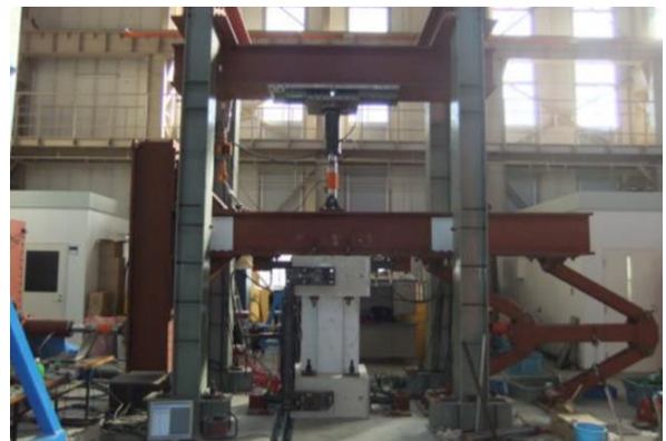
図 6.多目的載荷装置
