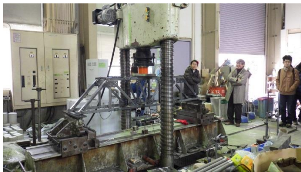
図8.載荷中の橋梁
