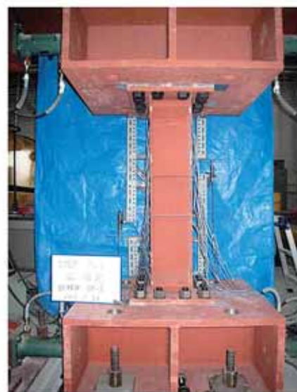
図9. 偏心ブレース架構のリンク部材実験
