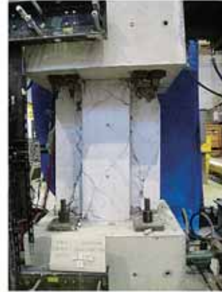
図7. 多目的載荷装置を使用した袖壁柱の実験
