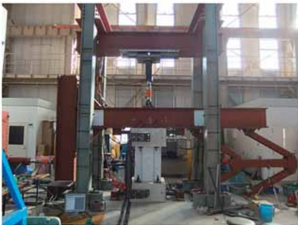
図 4. 多目的載荷装置
