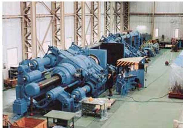
図 11. 大型強度試験機
