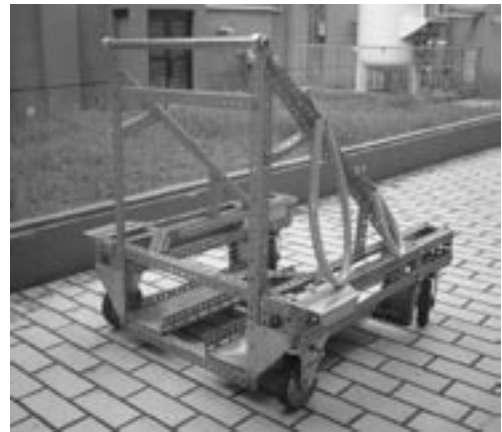
写真 8 完成した運搬車
