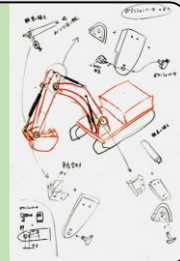
ショベルカーモデルへのセンサ取付
