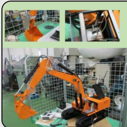
ショベルカーモデルへのセンサ取付
