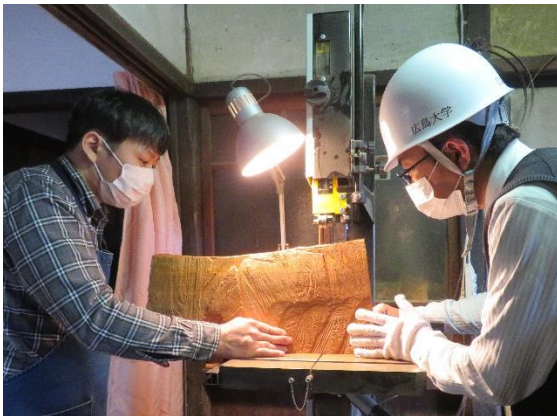
2021年12月ヒロシマエバヤマザクラ製材の様子 鉋(かんな)がけの様子
