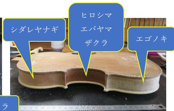
2022年2月楽器本体の製作途中の様子 側板の上部、中部、下部 背板と象嵌細工(白い部分)(全体にニスは塗っていない状態)
