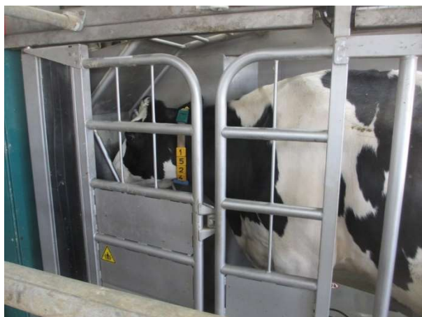
写真2 搾乳ロボットにおける搾乳牛でのスニファー法による呼気ガス測定（エサ箱の中のガスをポンプで吸引し、別室のガス分析計で濃度を分析する）
