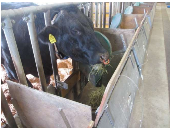
写真3 ドアフィーダーにおける黒毛和種肥育牛でのスニファー法による呼気ガス測定（エサ箱の中のガスをポンプで吸引し、別室のガス分析計で濃度を分析する）
