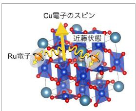
図 2  $CaCu_3Ru_4O_{12}$ の結晶構造。銅(Cu、青)の 局在したスピンがルテニウム(Ru、灰色)の 電子と相互作用して、近藤効果を引き起こす。
