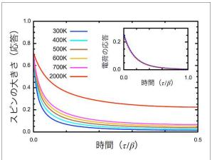
図3 銅(Cu)のスピンのダイナミクス。近藤効果によりスピンが遮蔽されるため、時間(横軸)とともにスピンの大きさ(縦軸)が減少する。
