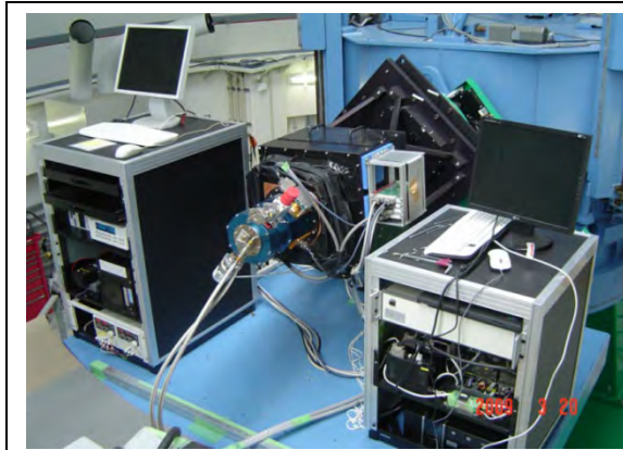
図 5-6 第1ナスミス焦点に取り付けられた HOWPo1 とその周辺機器
