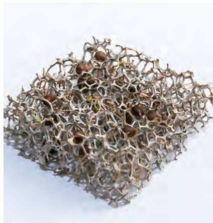
実験に使ったステンレス製多孔体。
