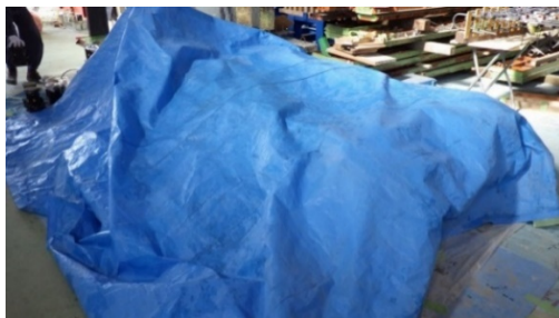
図 7.ブルーシートで覆われた養生中の供試体
