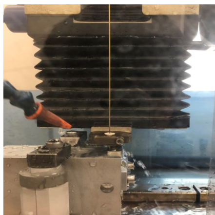
図 10. 細穴放電加工機による加工
