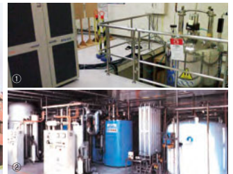
①高分解能核磁気共鳴装置 ②ヘリウム液化システム
